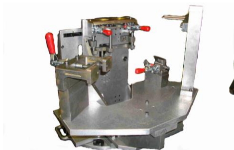
Montage de soudure
